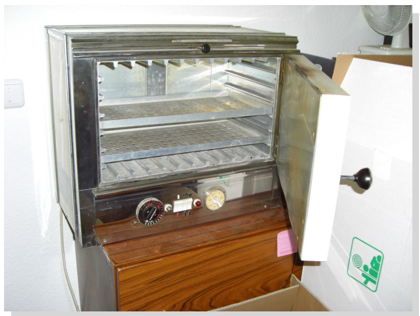
Heißluftsterilisateur mit fehlender Türdichtung sowie Ablagerungen auf der Oberkante der Tür (Bildquelle: Gesundheitsamt Region Kassel)
