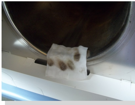
Ablagerungen in einem Sterilisationsgerät (Bildquelle: Gesundheitsamt Region Kassel)
