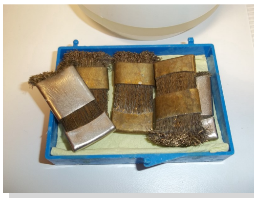
Metallbürsten zur manuellen Säuberung von Instrumenten verursachen schadhafte Oberflächen. Bildquelle: Gesundheitsamt Region Kassel)
