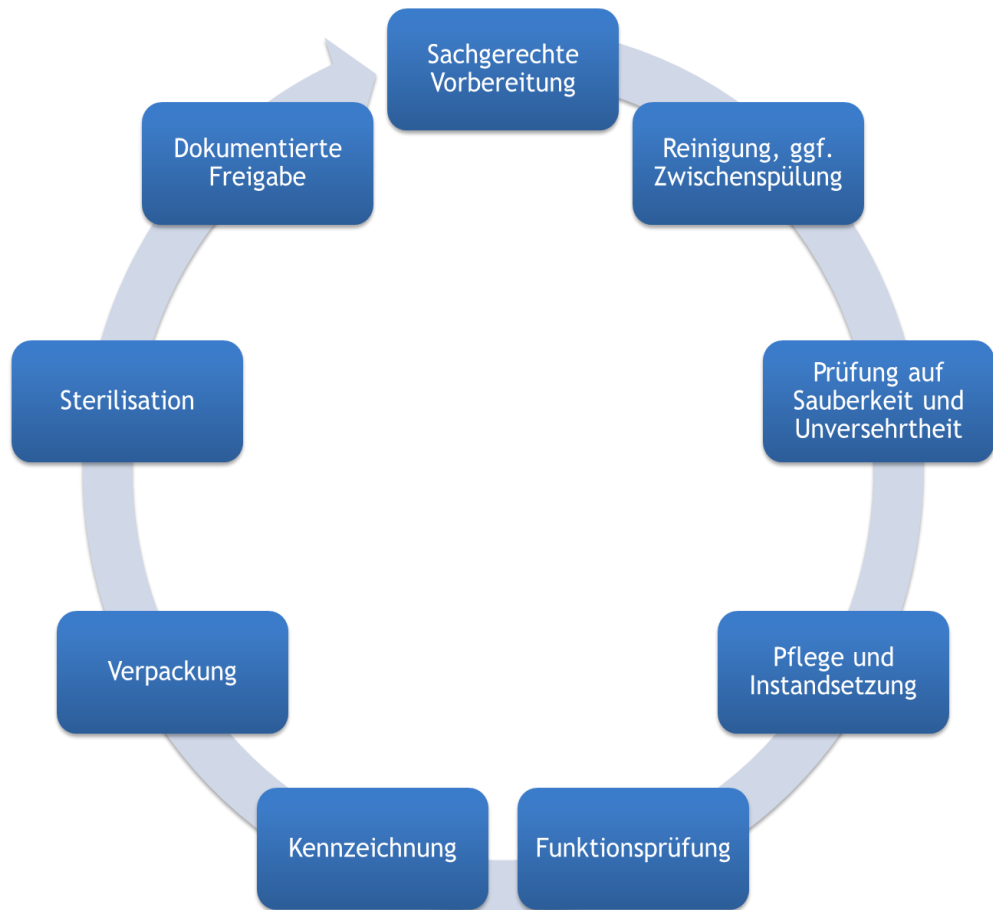
Abbildung 6 Aufbereitungskreislauf nach KRINKO/BfArM 2012
